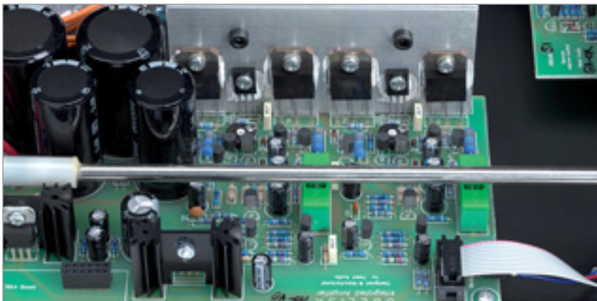
Kurze Signalwege und effiziente Wärmeableitung der Endstufentransistoren
